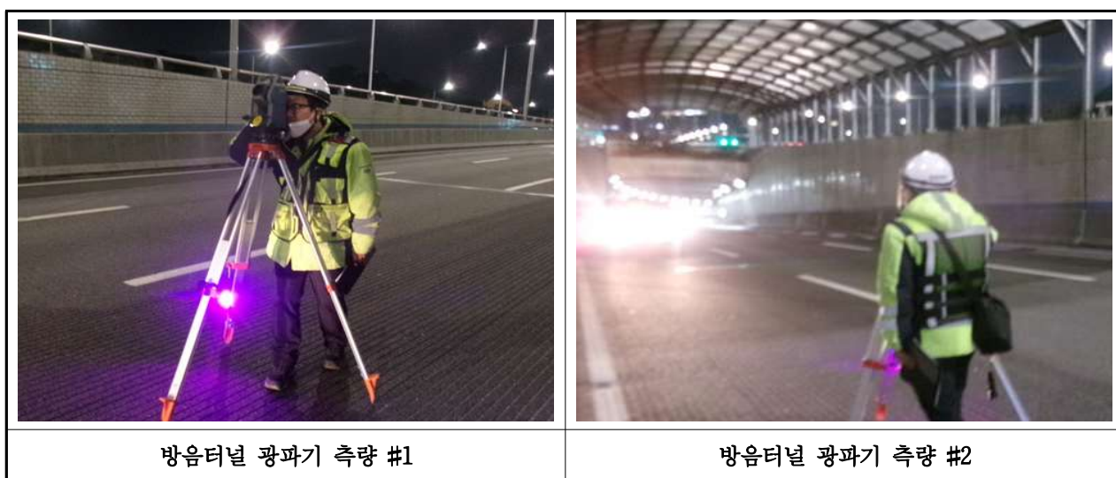
【사진 3.6.2】 광파기를 이용한 변위·변형 측량 현장사진
