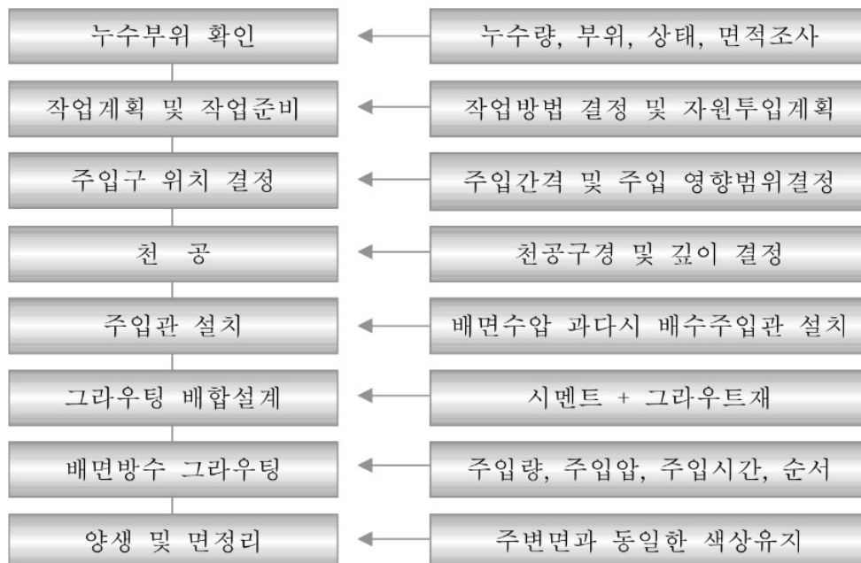
【그림 6.3.12】 배면주입방수 공법의 시공순서도
